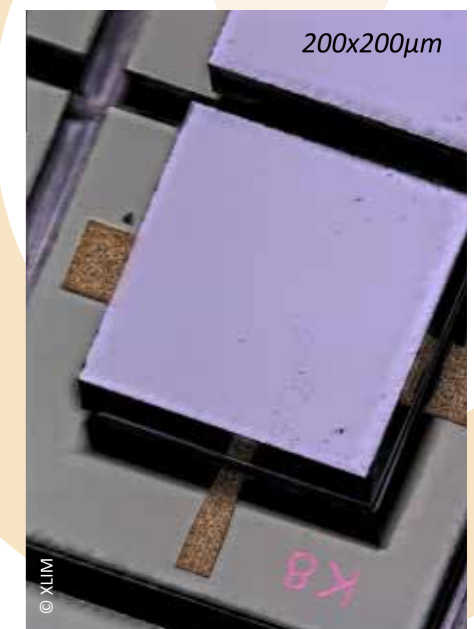
Réseau de capacités commutées MEMS-RF pour les antennes de systèmes de communications mobiles.
