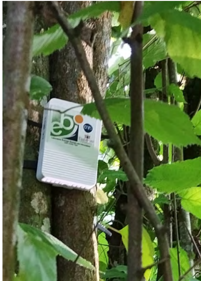
Capteur enregistrant, en temps réel, les températures et l'hygrométrie des zones équipées.
