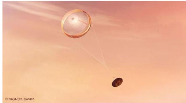
Au cours de cette phase, la sonde entame aussi sa navigation autonome assistée par l'imagerie de terrain (*Terrain-Relative Navigation*). Une caméra pointant vers le sol, capture en continu les images et les envoie à l'ordinateur de bord. Il détermine rapidement la position de la sonde par rapport à la surface de Mars, détecte les obstacles ou les accidents de terrain et sélectionne l'endroit le plus sûr où atterrir. Ce système peut ajuster de 600 mètres le point d'atterrissage du rover.
