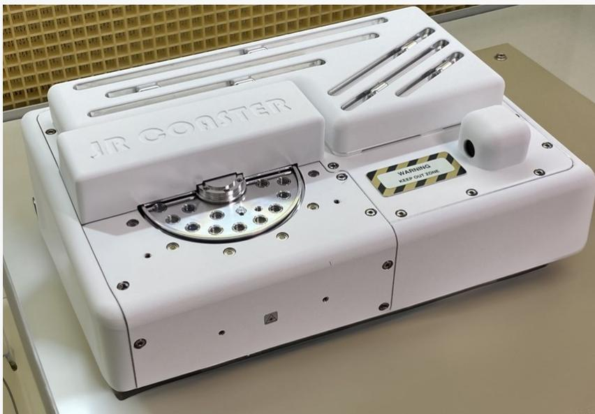
L'expérience IR-Coaster, à la fin de son assemblage au LISA, avant son départ pour la Station spatiale internationale (dimensions et masse environ 40x30x15 cm et 10 kg). Les échantillons sont disposés dans le carrousel dont une moitié est visible sur la photo. L'instrument d'analyse infrarouge est à l'intérieur du boîtier. (Crédit photo : H. Cottin)
